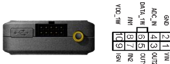
Belegung der Pins am GV65L Stecker:
